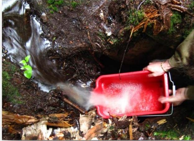
**Figure 6** Jaugeage capacitif au seau
