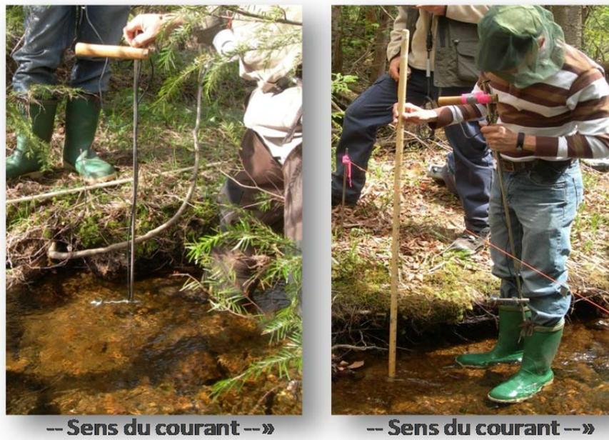
Figure 7 Mesures au micromoulinet (gauche) et de la hauteur d'eau (droite)
